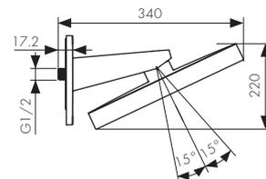
**Регулируемый угол наклона** кронштейна позволяет установить поток воды в комфортном положении
