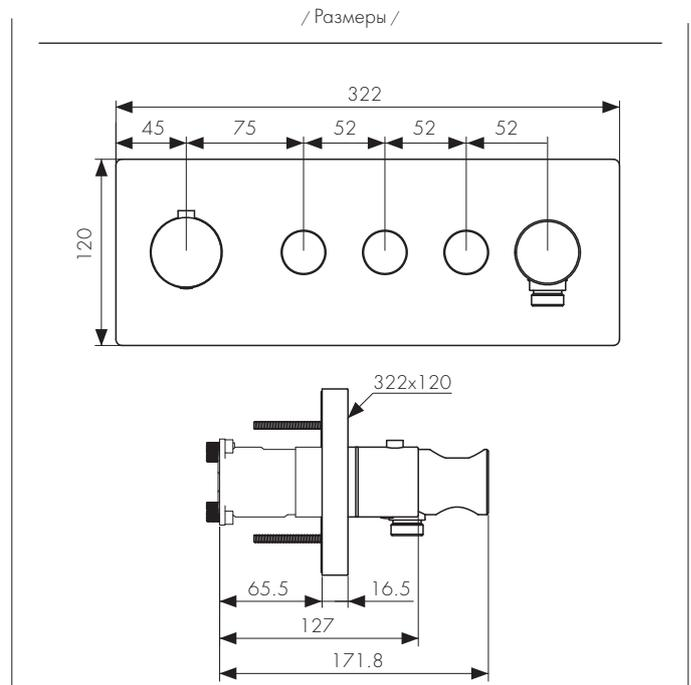
Смеситель для душа скрытого монтажа с термостатом, 3-х режимный, со шланговым подключением и держателем для ручной лейки, латунь
