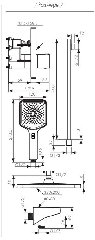
Смеситель для душа скрытого монтажа с термостатом, 2-х режимный, латунь
