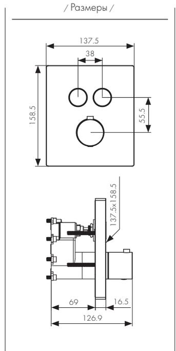
Смеситель для душа скрытого монтажа с термостатом, 2-х режимный, латунь
