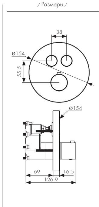
Смеситель для душа скрытого монтажа с термостатом, 2-х режимный, латунь
